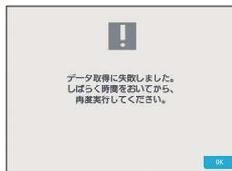
また、停電などで情報収集ユニットの時刻が設定されていない状態になるとデータの取得に失敗します。右の画面が表示された場合には、情報収集ユニットの時刻を再設定してください。(P108ページ)
