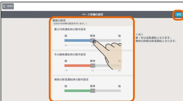
「空調のモード」で「おまかせON」を選択した場合は、ベース空調の運転動作を季節ごとに設定します。夏の冷房運転の温度設定、冬の暖房運転の温度設定、梅雨の時期の除湿運転の強弱を設定します。なお、春・秋は送風運転になります。
