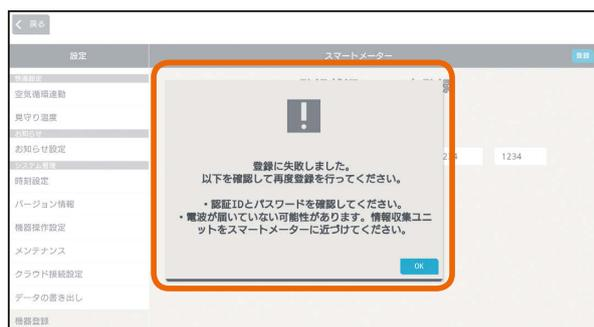
Bルートサービスの認証ID・パスワードを正しく入力しても、スマートメーターとの認証・接続に失敗する場合は、スマートメーター対応USBドングルの電波がスマートメーターに届いていない可能性があります。スマートメーター対応USBドングルを取り付けた情報収集ユニットをスマートメーターに近づけて、再度①から接続・認証をお試しください。
