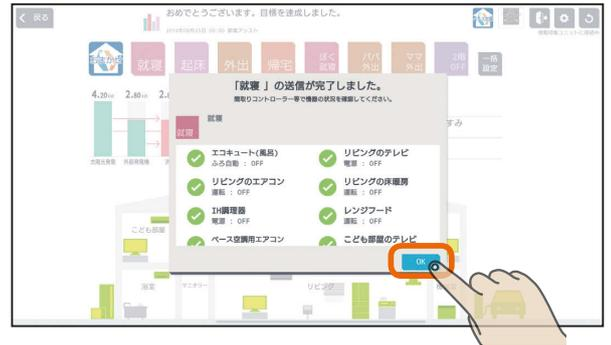
一括設定で設定できなかった機器には「？」が表示されます。「？」が表示されたときは、該当する機器の接続などを確認して操作をやり直してください。
