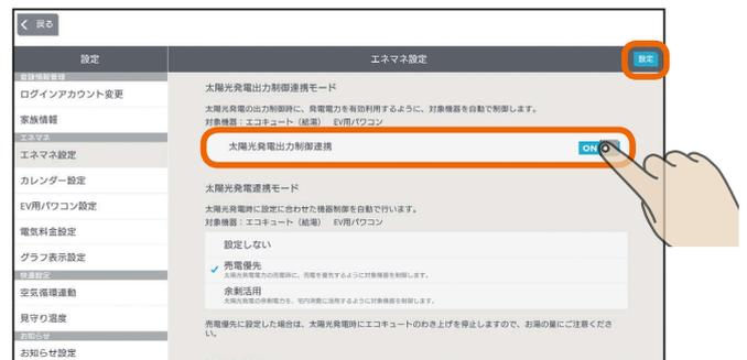
太陽光発電の出力制御時に、発電電力を有効利用するように対象機器を自動で制御します。
